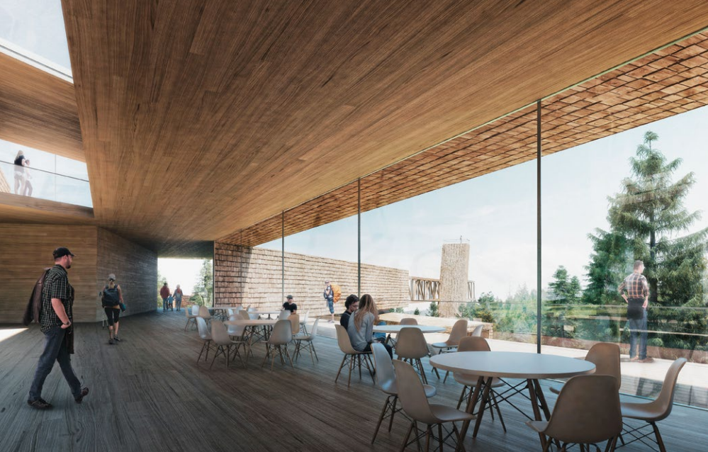
Ein Paradebeispiel für modernes Bauen mit Weißtanne ist das noch im Bau befindliche Info-Zentrum des Nationalparks Schwarzwald. Brettsperrholz aus Weißtanne prägt das gesamte Gebäude-Ensemble.
