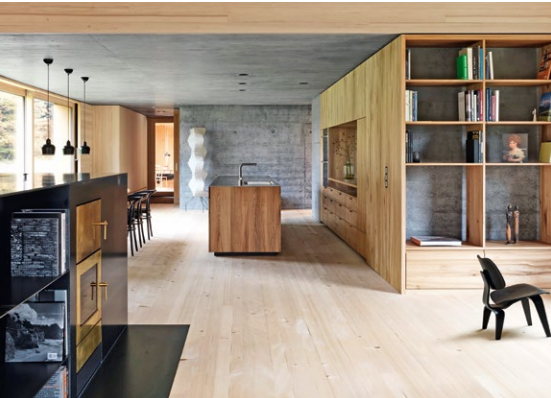
Moderner Innenausbau mit Weißtanne (ob.)
